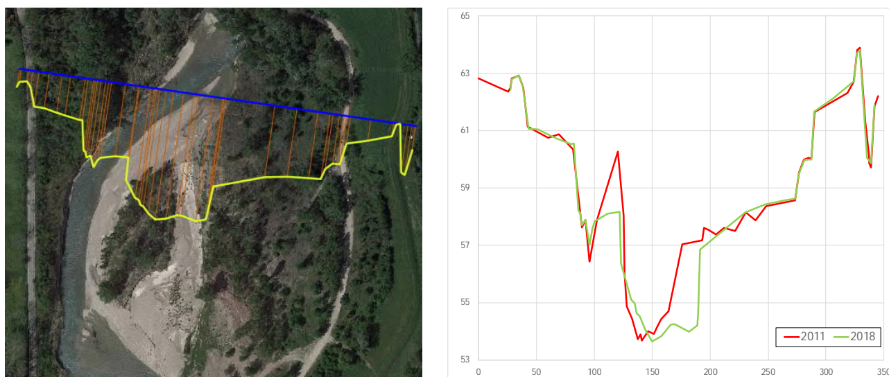
Figura 2.1 – Sezione EN_65, in Sx posizione planimetrica con sovrapposizione della sezione 2018, in Dx confronto sezioni 2011 e 2018.
